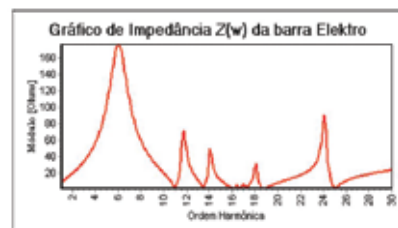
Figura 10 – Impedância versus frequência na tensão de 13,8 kV
