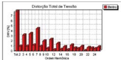
Figura 9 – Distorção harmônica total de tensão no 13,8 kV com os bancos de capacitores existentes
